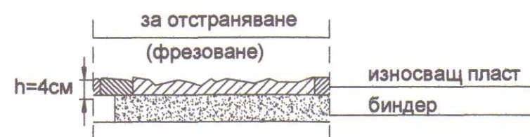
ДЕТАЙЛ No1 - Фрезование на повредени площи
