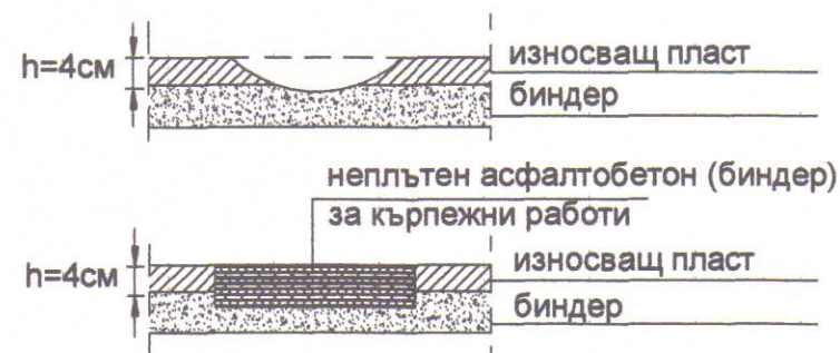
ДЕТАЙЛ No4 - Изкърпване на дупки
